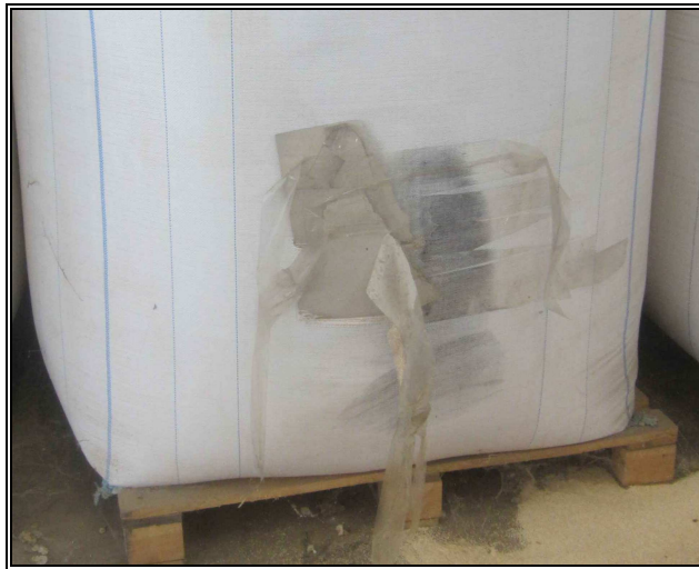
Fig. 8: es. di riparazione con nastro adesivo da svolgere solo in adeguate condizioni di sicurezza
